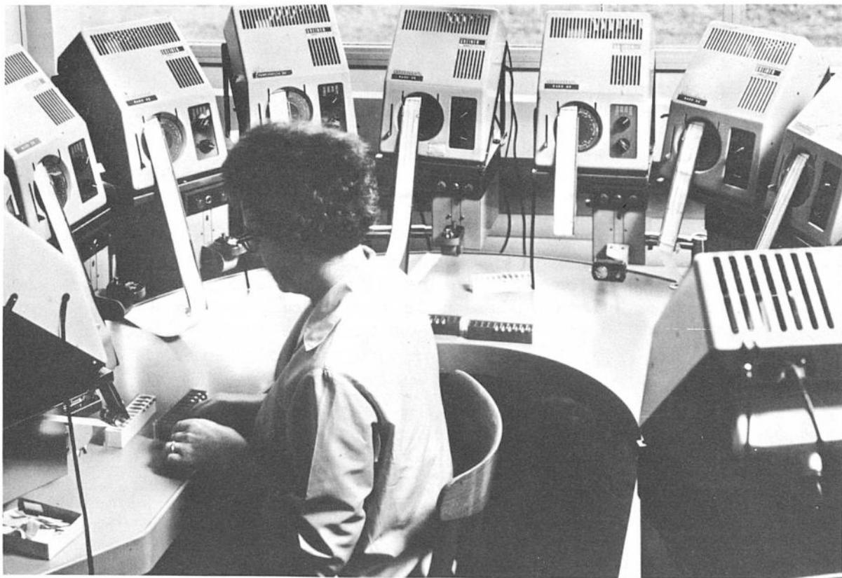
Contrôle final des mouvements d'horlogerie avant l'emboîtement et la pose du cadran. Chaque mouvement est contrôlé individuellement. En raison des méthodes d'assemblage modernes utilisées actuellement, de tels postes de contrôle ont une importance primordiale.
